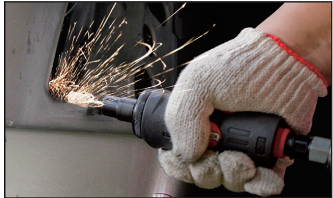
► Operation of Mini Die Grinder
